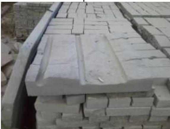
Figura 22: Produto 1 fabricado com casqueiro.
