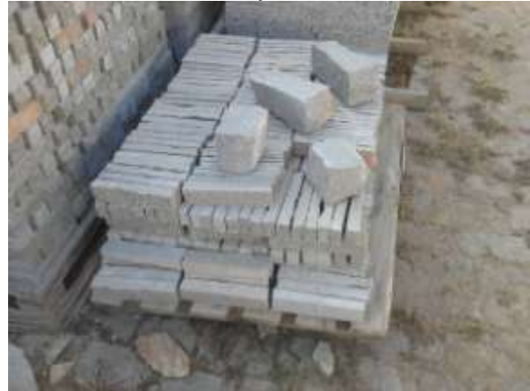
Figura 25: Produto 4 fabricado com casqueiro.
