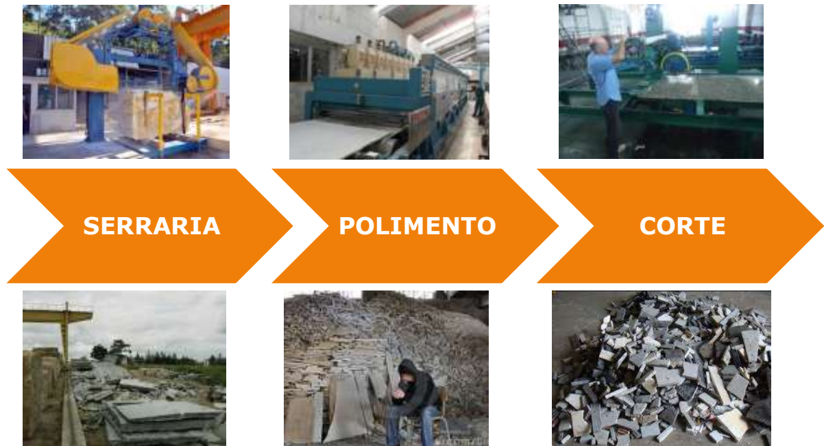
Figura 1: Cadeia de beneficiamento de mármore e granito, com suas respectivas tecnologias normalmente utilizadas e resíduos gerados.
