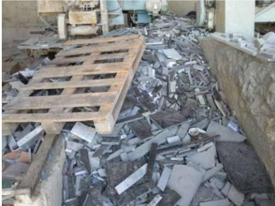
Figura 15: Caco gerado no corte e acabamento de chapas de mármore e granito.
