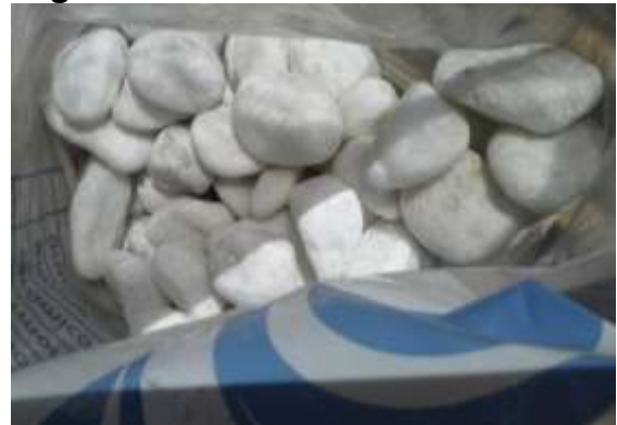
Figura 29: Granilha fabricada com caco
