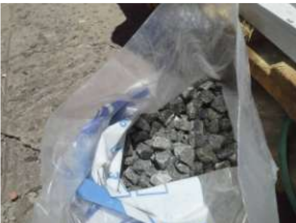
Figura 28: Brita decorativa fabricada com caco
