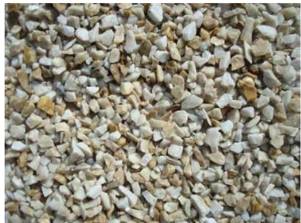
Figura 29: Granilha fabricada com caco
