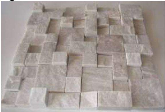
Figura 28: Brita decorativa fabricada com caco
