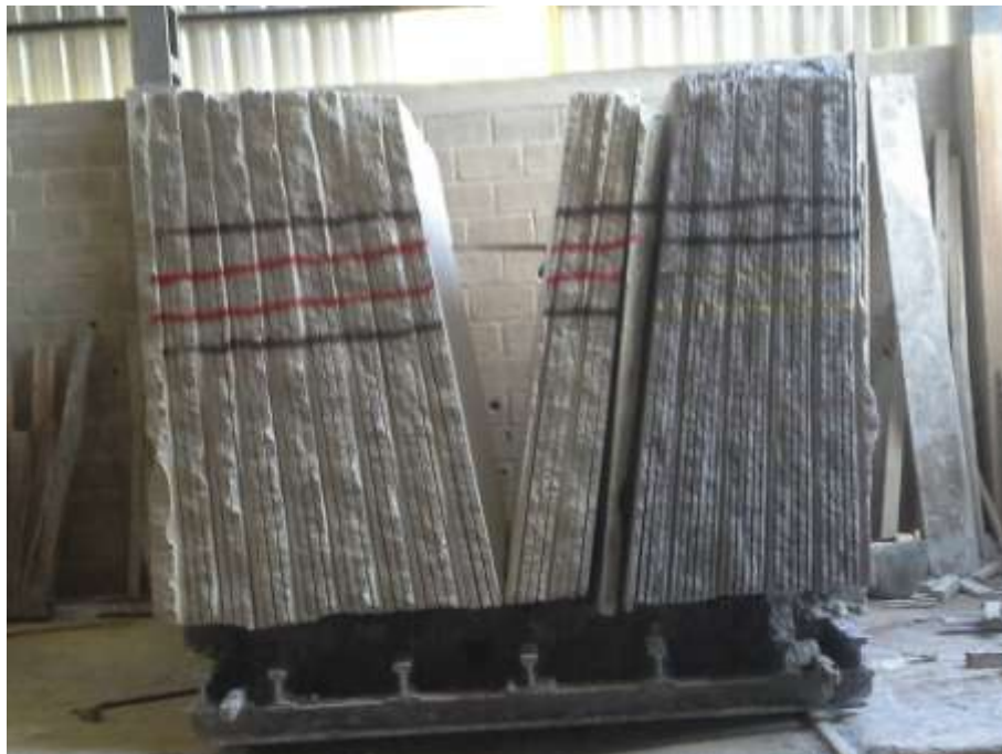
Figura 19: Exemplo de serragem de blocos "interas".
