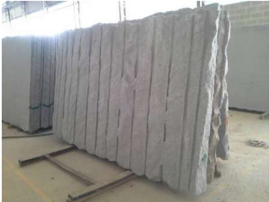
Figura 14: Casqueiro gerado na serragem do bloco de mármore e granito.
