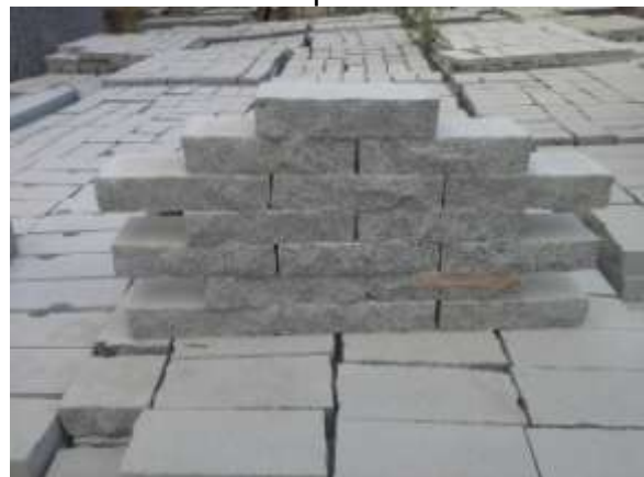
Figura 23: Produto 2 fabricado com casqueiro.
