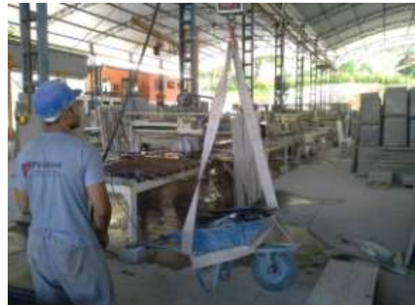
Figura 17: Tara do carrinho para medição da geração de cacos nas marmorarias.
