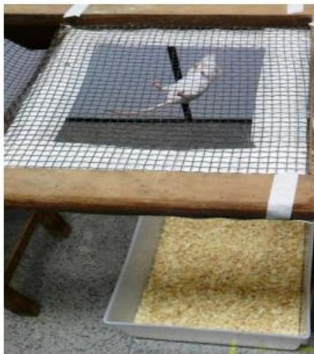
**Figura 5:** Demonstração do teste de resistência de agarre. Fonte: Moraes, 2014
