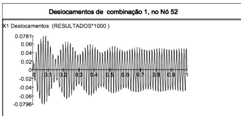
Figura 74: Deslocamentos em X2 da combinação 1 no Nó 52 da estrutura semirrígida.
