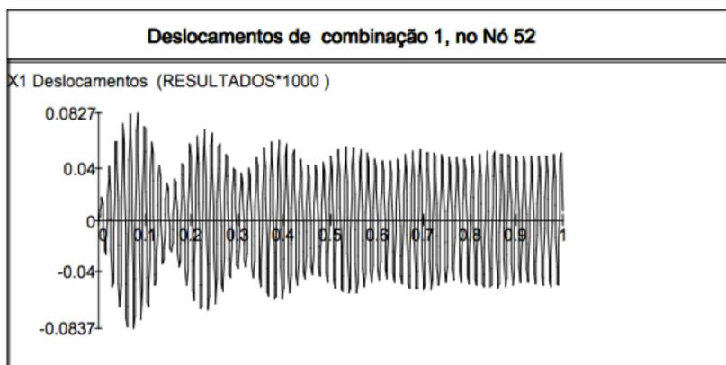
Figura 76: Deslocamentos em X2 da combinação 1 no Nó 52 da estrutura rotulada.
