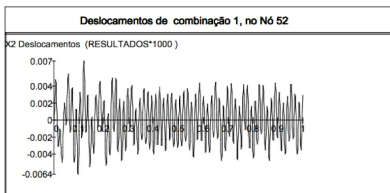
Figura 75: Deslocamentos em X1 da combinação 1 no Nó 52 da estrutura rotulada.
