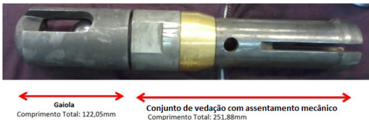
Figura 14 - Válvula de pé utilizada neste trabalho incluindo as principais partes e dimensões.
