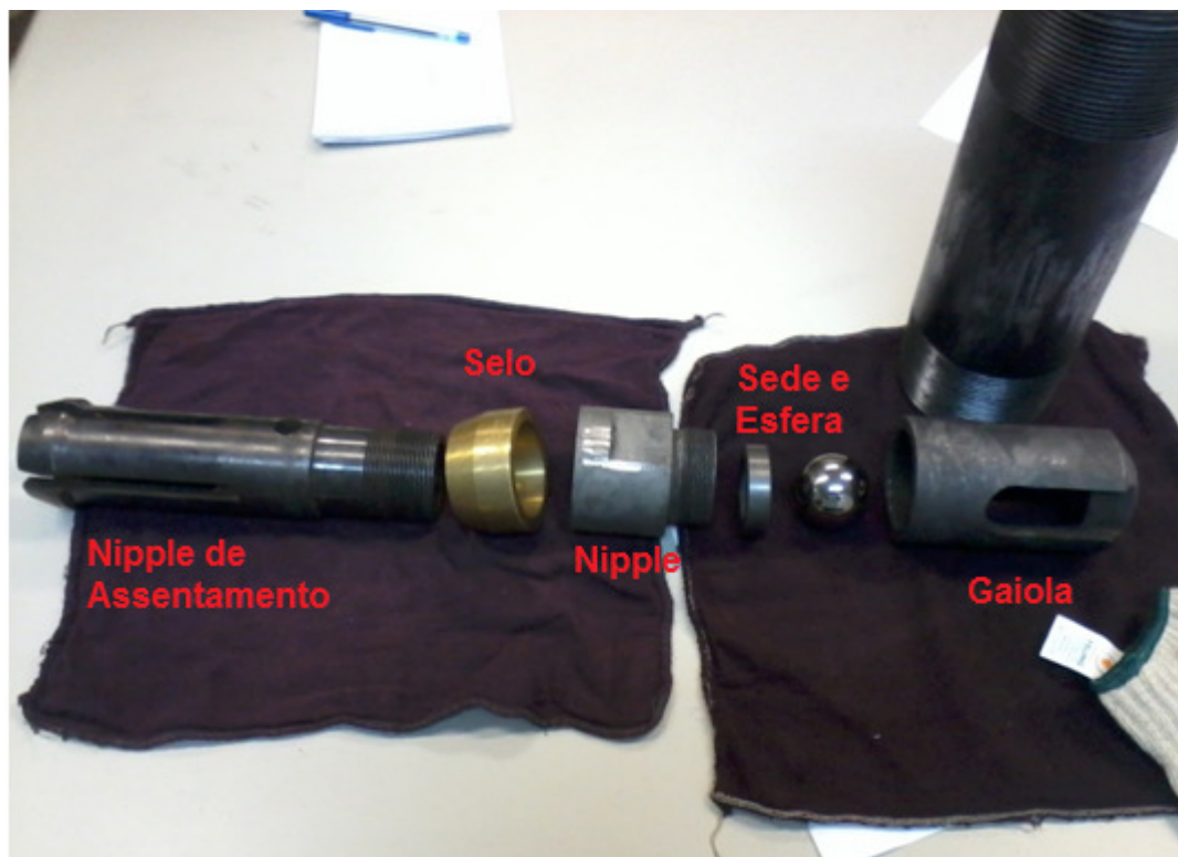
Figura 8 - Vista explodida da válvula de pé.
