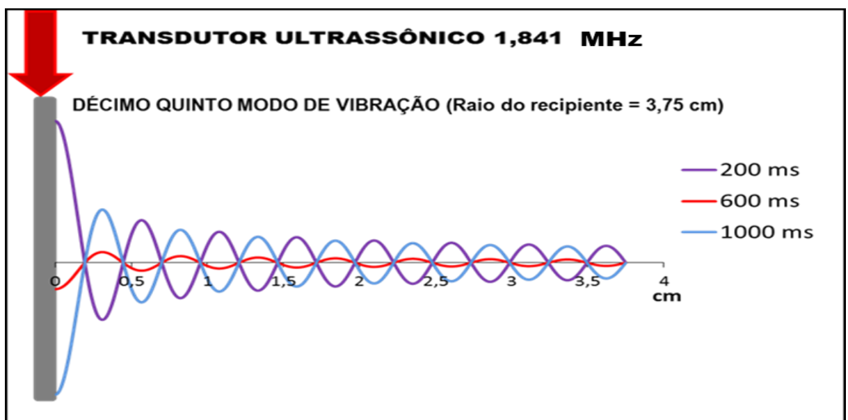
Figura 24: Modelo computacional para um transdutor de frequência 1,841 MHz operando em seu décimo quinto modo de ressonância. Para cada modo de vibração é apresentado três momentos da onda, representando um período: 200 ms (roxo), 600 ms (vermelho) e 1000 ms (azul).
