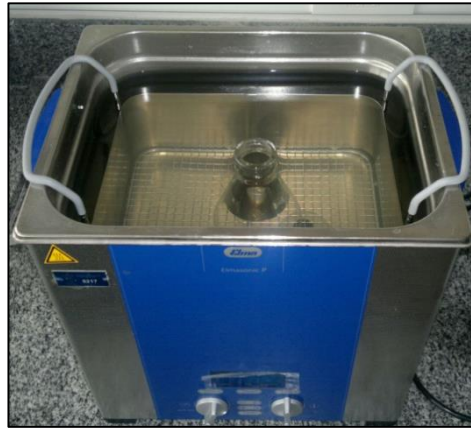
Figura 9: Vista superior de um banho ultrassônico contendo frasco reacional.
