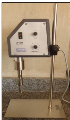
Figura 10: Vista lateral de uma sonda ultrassônica.
