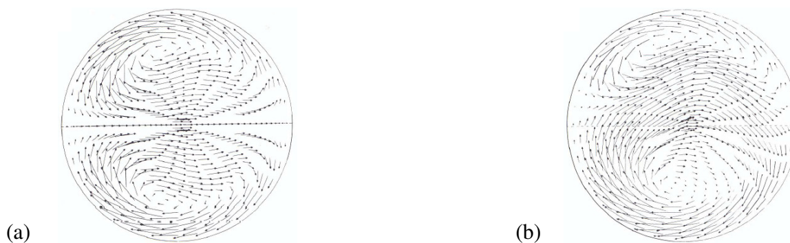
Figura 3.3 – Escoamento secundário em tubos curvos com (a) torção igual a zero e (b) torção diferente de zero Fonte: Kao (1987).
