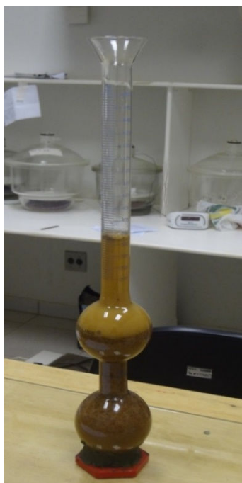
Figura 13 - Tubo de Chapman para determinação do peso específico do sedimento.
