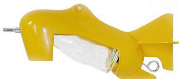
Figura 8 - Amostrador de sedimento em suspensão USDH-59 (AMS-3).
