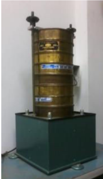
Figura 12 - Peneiras para análise granulométrica pelo Método de Peneiramento.
