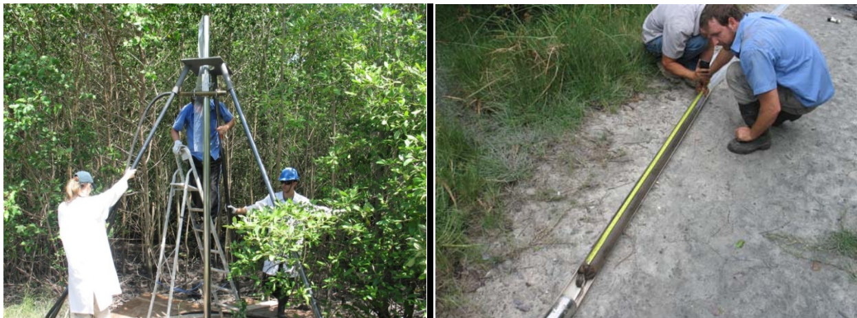
Figura 11. Vibrotestemunhador utilizado no mangue e testemunho preservado (2m) obtido nesta amostragem (Foto: arquivo pessoal).
