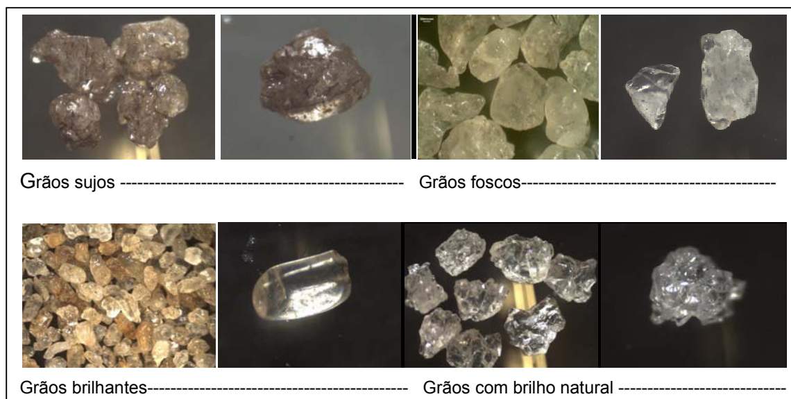
Figura 52. Exemplificação dos tipos de grãos utilizados para os agrupamentos. Todos os grãos apresentam diâmetro de 0,5 mm (1 phi). (Fotos: arquivo pessoal)
