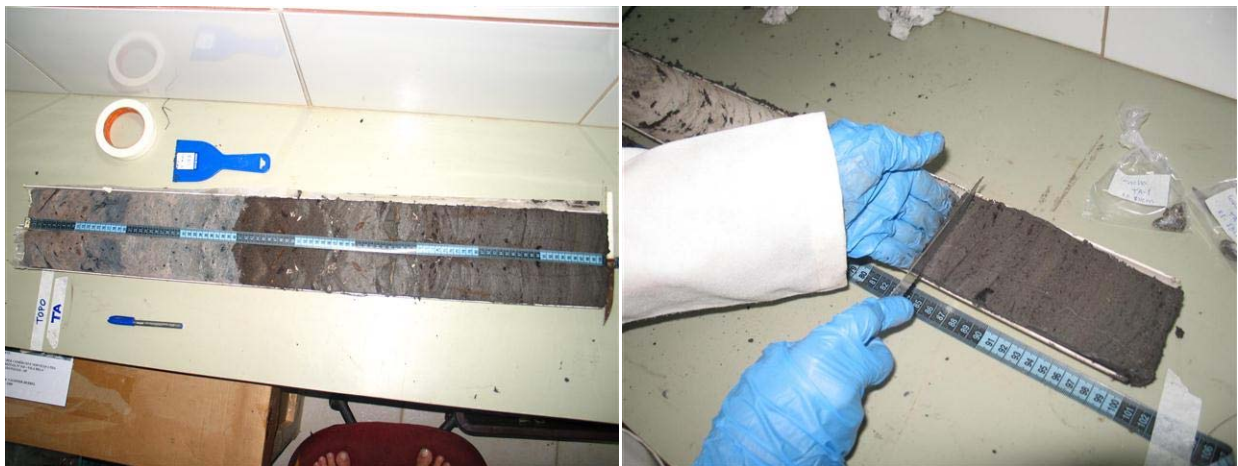
Figura 10. Testemunho aberto para descrição visual e fatiamento a cada centímetro para separação das amostras
