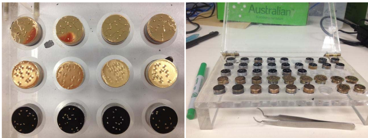
Figura 16. Preparação dos grãos de quartzo para o MEV. A: grãos colados sobre a fita adesiva (preta) sobre tocos de alumínio posteriormente revestidos por uma fina camada de ouro. B: caixa para acomodar as amostras para análise de microtexturas. (Foto: arquivo pessoal).
