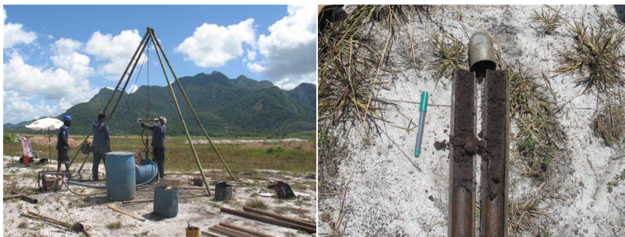
Figura 9. Fotos dos equipamentos utilizados na sondagem SPT. Em detalhe o amostrador utilizado para coletar sedimento a cada metro de perfuração.
