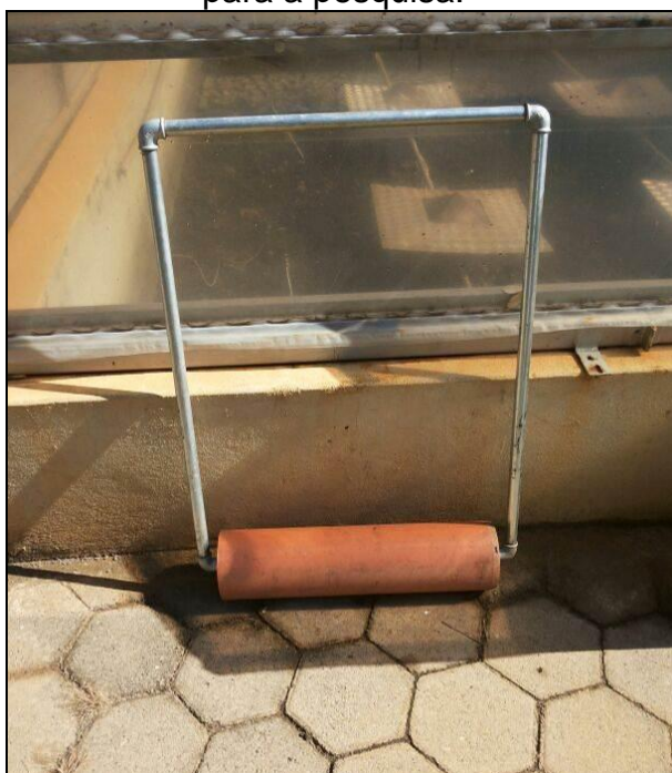
Figura 5 – Rolo compressor desenvolvido para a pesquisa.
