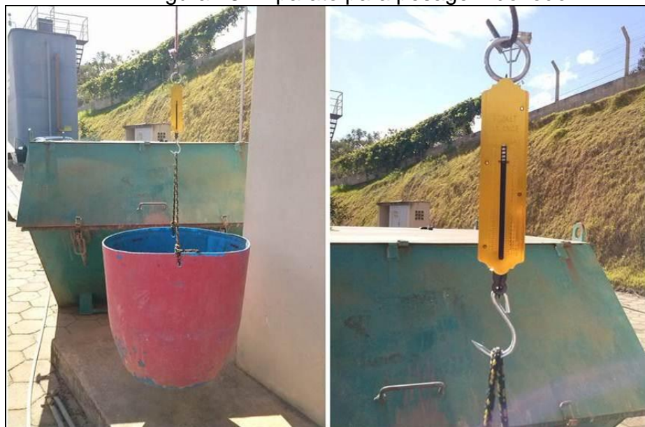
Figura 18 - Aparato para pesagem do lodo.
