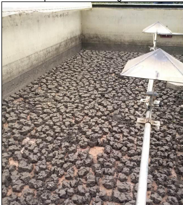
Figura 4 – Torrões de lodo formado no processo de secagem.
