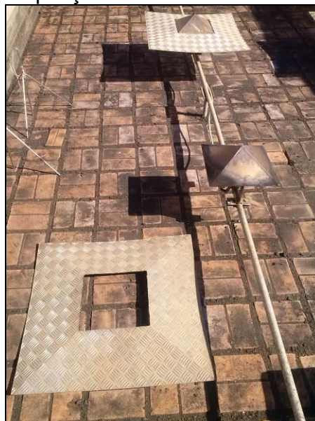
Figura 8 - Queimadores com ampliação móvel em alumínio.
