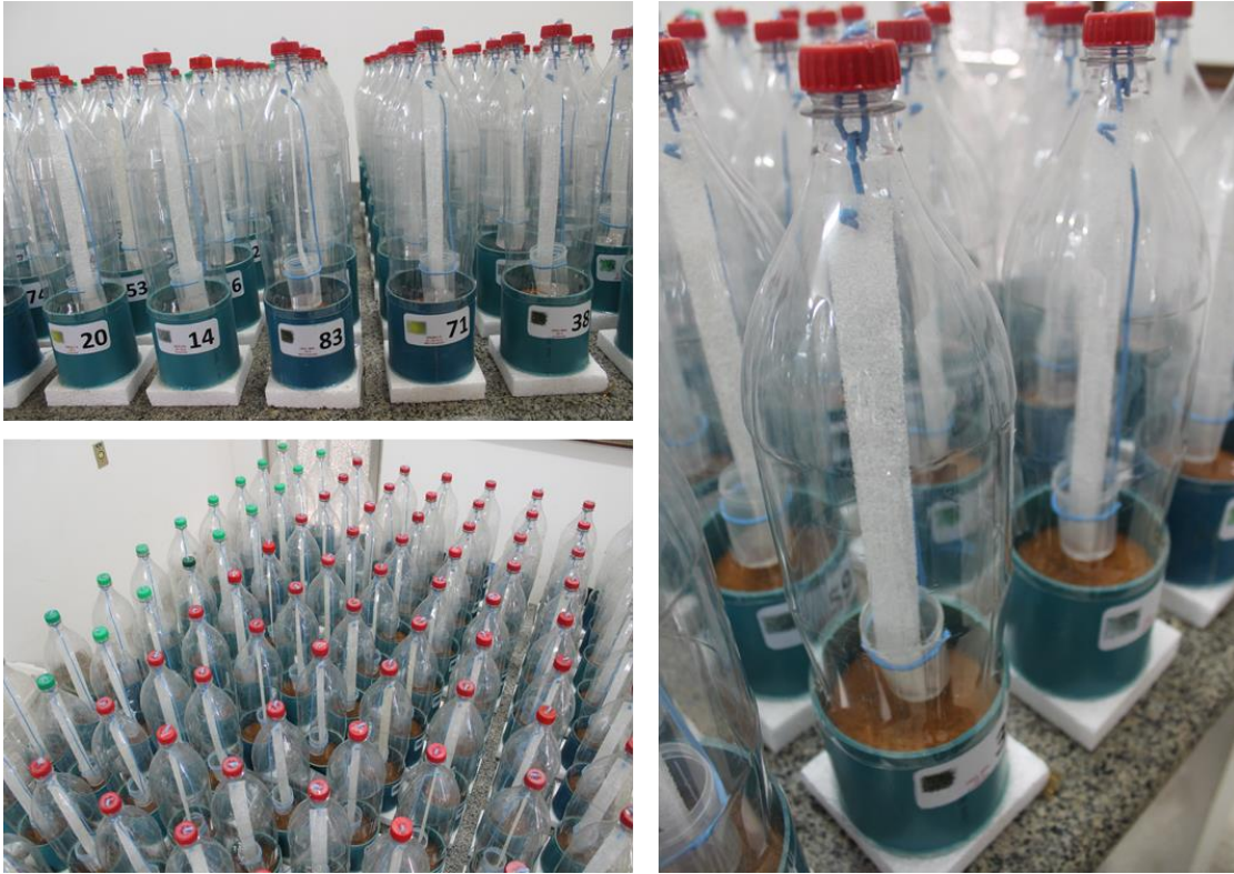
Figura 2A. Experimento de volatilização conduzido em ambiente controlado utilizando os coletores tipo SALE.
