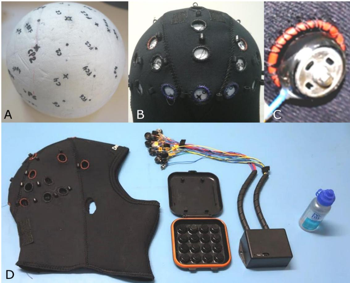
Figura 12 - Equipamento EEG modificado. A) modelo construído baseando em coordenadas esféricas. B) Plotagem dos pontos do modelo para a touca de neoprene. C) *O-ring* segurando eletrodo na touca. D) Equipamento EEG modificado completo. Fonte: Elaborado pelo autor, 2015.
