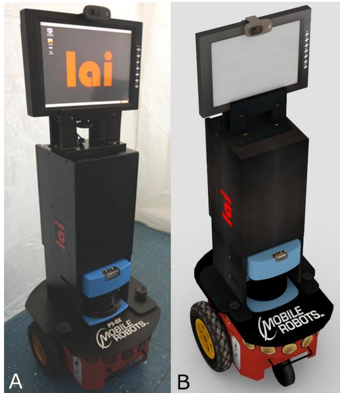
Figura 18 – TRON (Telepresence Robotic Navigation). A) Robô real. B) Modelo 3D do robô. Fonte: Elaborado pelo autor, 2015.
