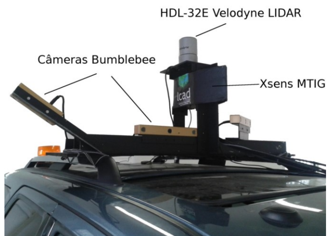
Figura 59: Sensores instalados na IARA.
