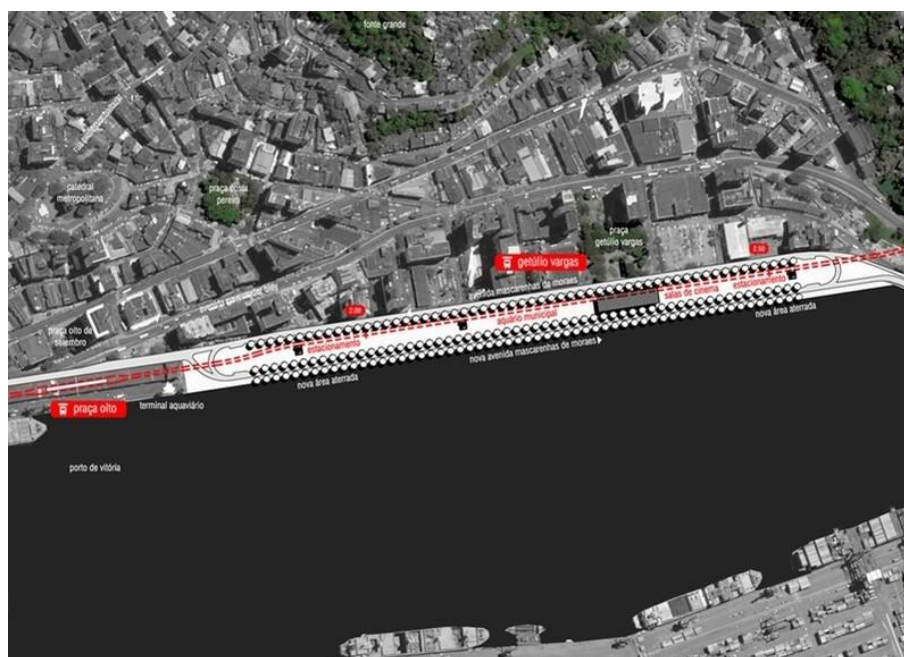
Figura 191 – Implantação das estações subterrâneas do VLT na Avenida Beira-Mar.
