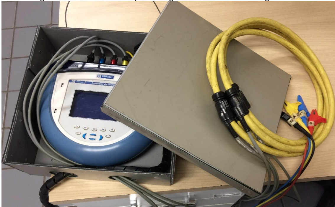
Figura 4 – Caixa em ACM para abrigar o Analisador de Energia Elétrica
