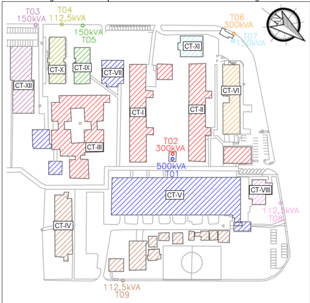
Figura 2 – Distribuição dos Transformadores do Centro Tecnológico
