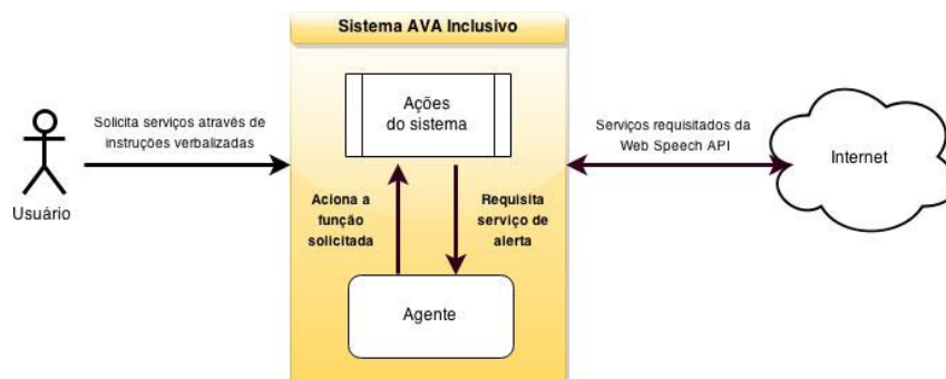
Figura 2. Esquema da arquitetura para reconhecimento de padrão vocal
