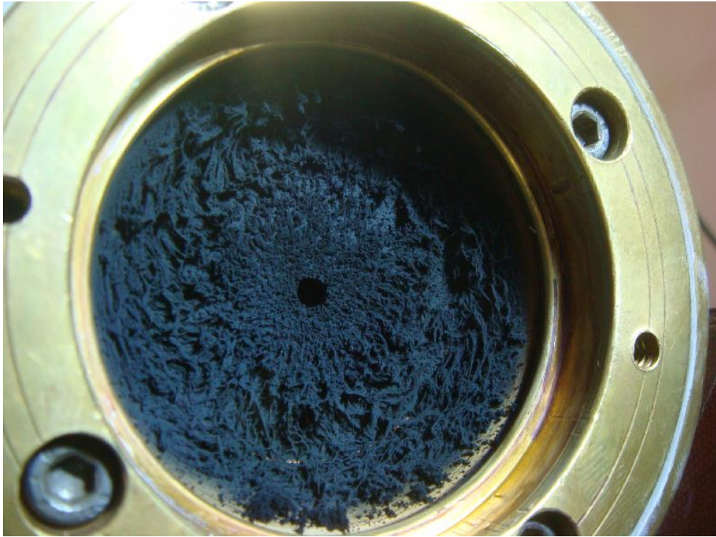
Figura 44 - Negro de fumo depositado na saída do primeiro anodo (5 mm).
