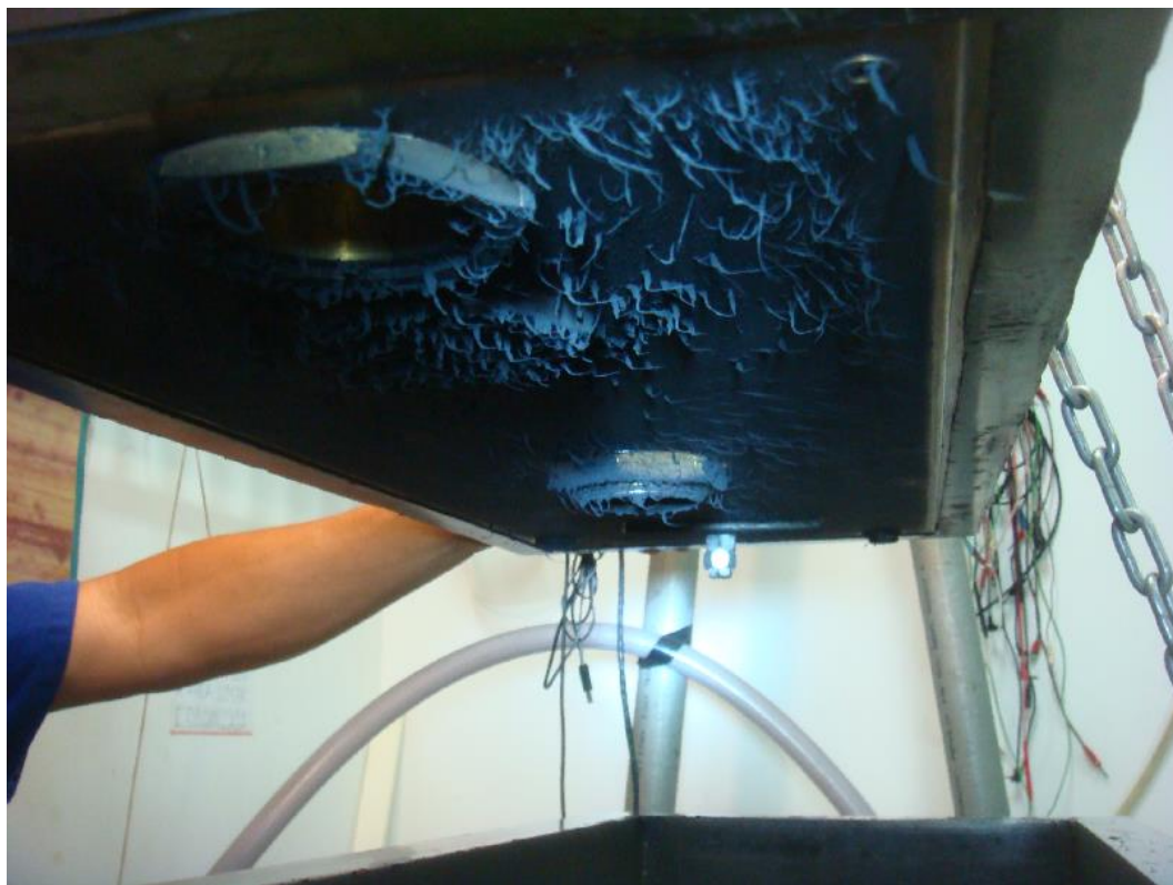
Figura 45 - Negro de fumo depositado na tampa do reator.
