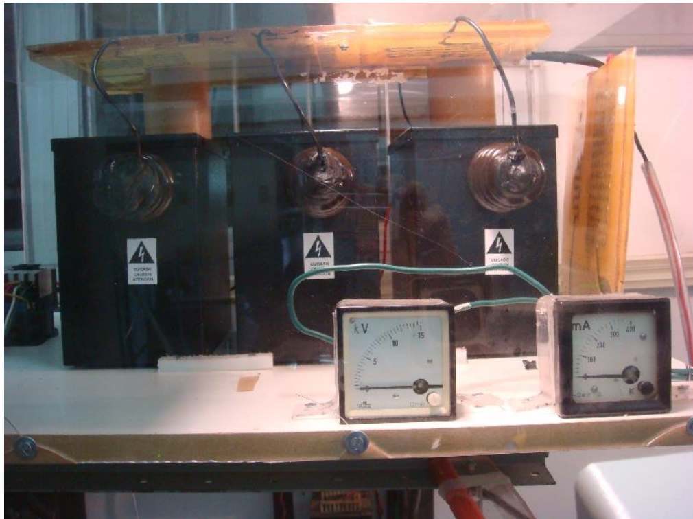
Figura 22 - Fonte de potencia DC para 12 kV e 90 mA, com entrada trifásica e ponte retificadora hexafásica.
