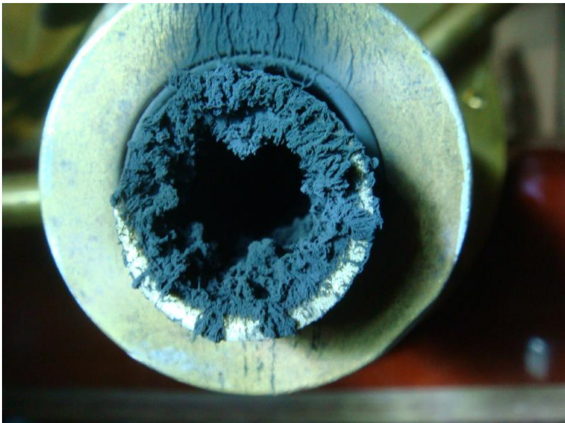
Figura 43 - Negro de fumo depositado na saída do segundo anodo após os testes.
