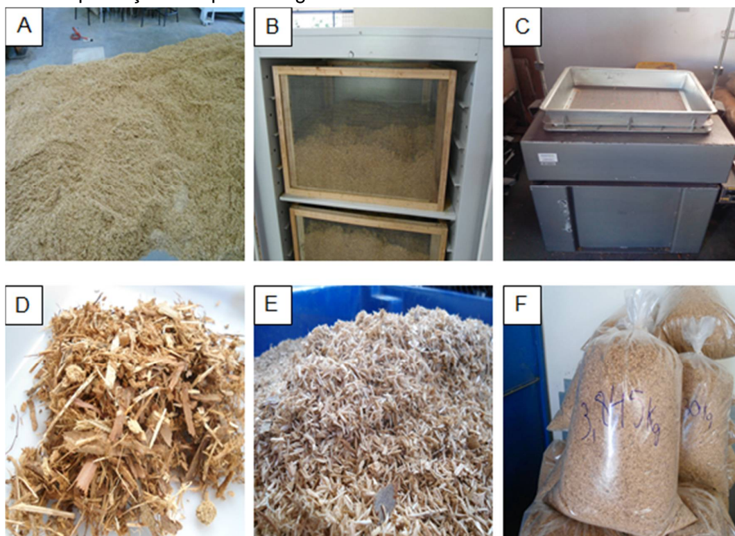
Figura 1 – Preparo do resíduo lignocelulósico. A = Secagem ao ar; B = Secagem em estufa; C = Peneirador; D = Casca; E = Resíduo lignocelulósico retido na malha de 2 mm; F= Armazenagem do resíduo lignocelulósico pronto para produção dos painéis aglomerados.
