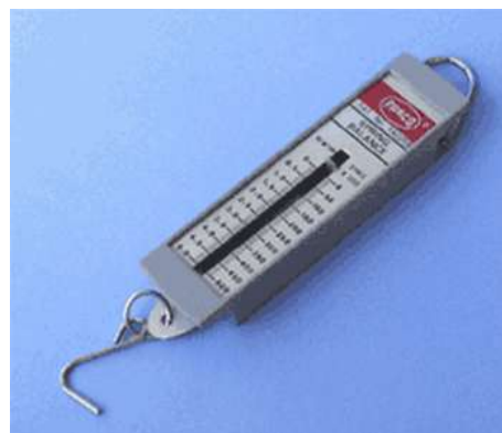
Fig 4.4: Dinamômetro, aparelho utilizado para medir força. Fonte: http://portaldoprofessor.mec.gov.br/fichaTecnicaAula.html?aula=19734 .
