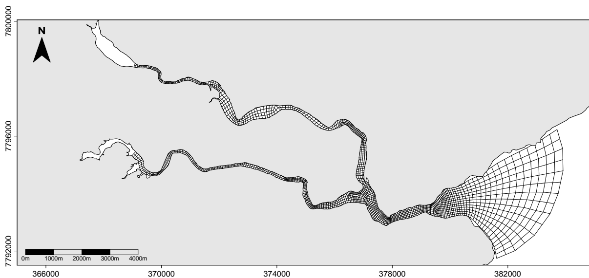
Figura 16: Malha de elementos quadrangulares utilizada para aplicação do modelo hidrodinâmico SisBahia® no SEPAPM
