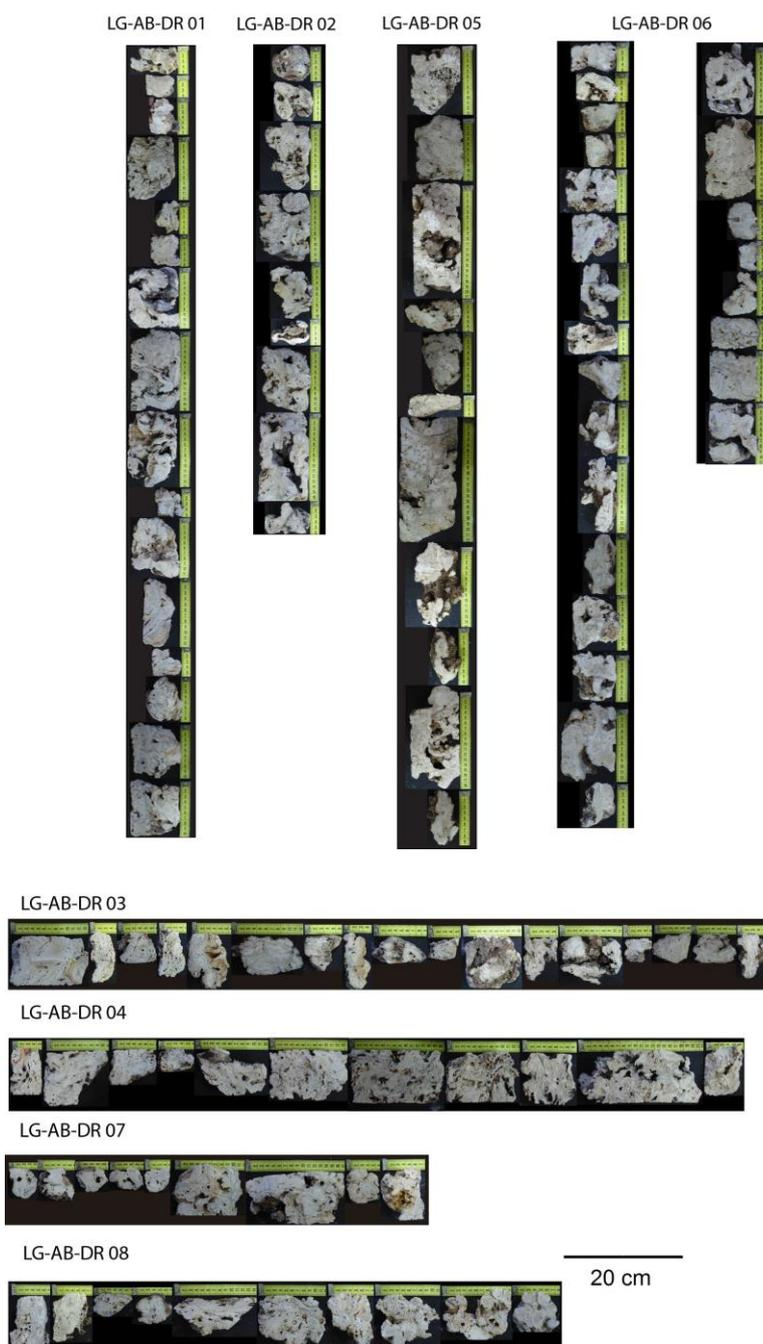
Figura 4: Fragmentos coletados a cada inserção de 50 centímetros do equipamento na estrutura recifal resultando nos testemunhos verticais LG-AB-DR 01, LG-AB-DR 02, LG-AB-DR 05 e LG-AB-DR 06 e nos testemunhos horizontais LG-AB-DR 03 e LG-AB-DR 04 LG-AB-DR 07 e LG-AB-DR 08. O testemunho LG-AB-DR 06 foi dividido em duas parcelas para melhor visualização da imagem.
