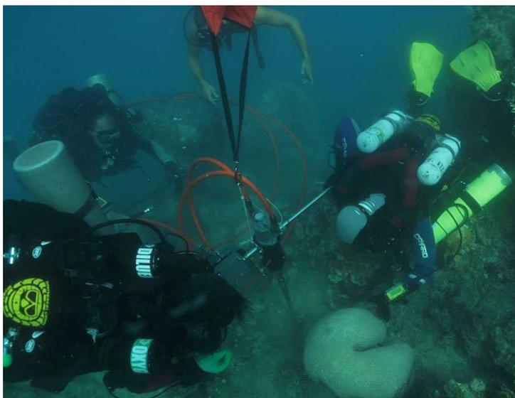
Figura 2: Sondagem a partir de Drill Pneumático.
