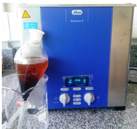
Figura 14: Banho de ultrassom utilizado e sistema de extração (OLUC + Solventes) em funil de decantação.
