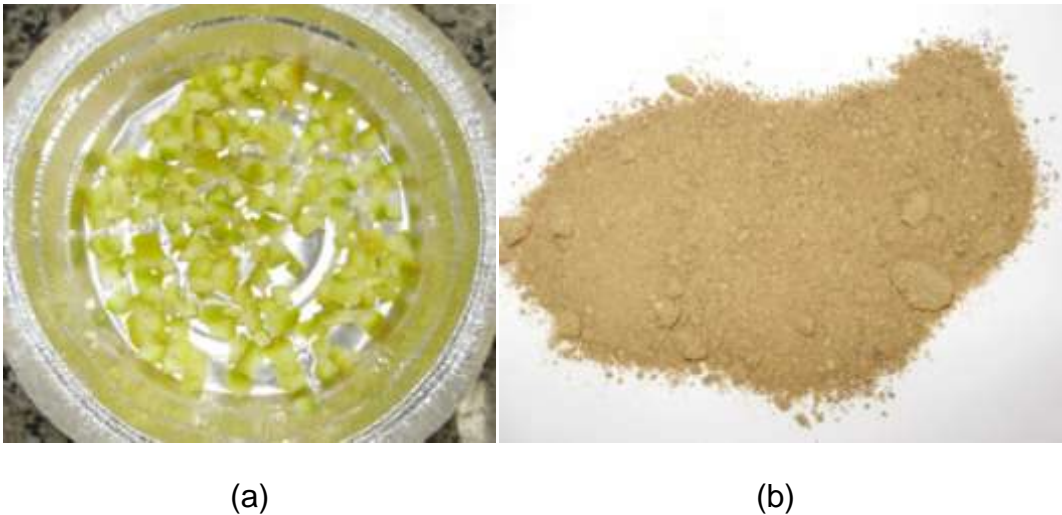
Figura 10 – Amostras de bagaço de laranja utilizadas para: (a) As análises de secagem convectiva; (b) As análises termogravimétricas.
