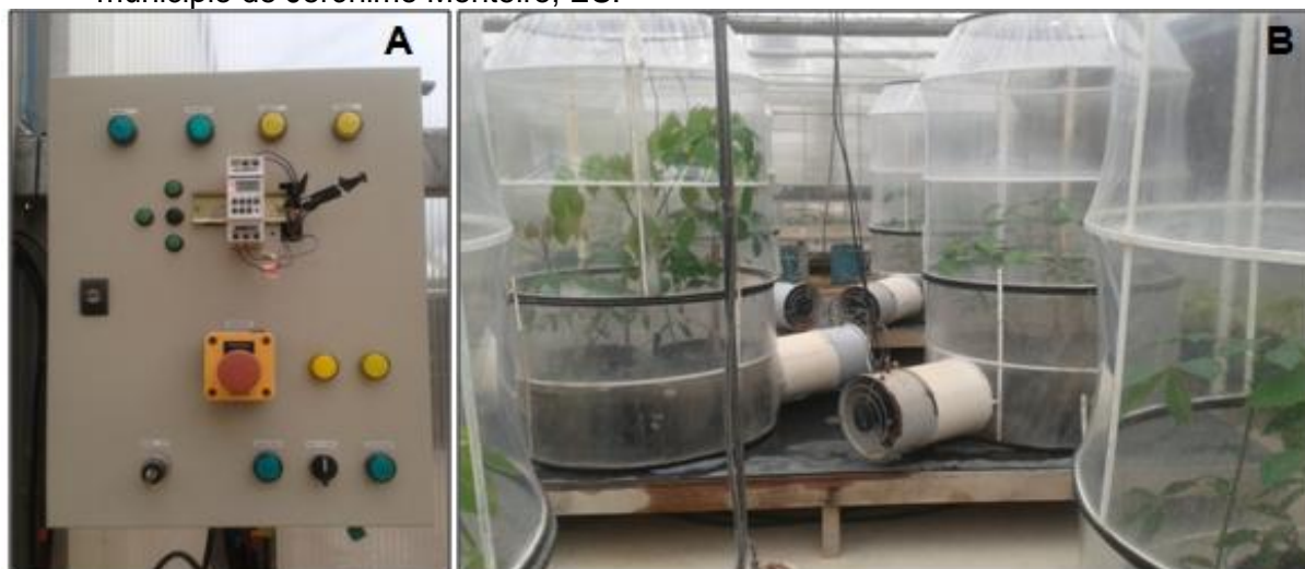
Figura 2: Painel de controle de injeção de CO 2 para o interior das câmaras de topo aberto (A) e distribuição das câmaras de topo aberto dentro das casas de vegetação (B) no município de Jerônimo Monteiro, ES.
