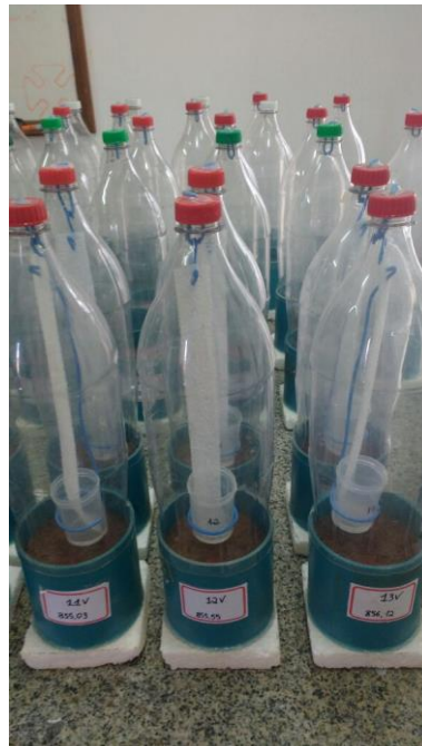
Figura 2 – Disposição das câmaras utilizadas para a captação da amônia volatilizada (1 a e 2 a fileiras), fluxo de CO 2 (3 a e 4 a fileiras) e atividade da urease (5 a e 6 a fileiras).
