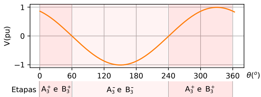
Figura 20 – Regiões de operação do braço 3 do inversor com suas respectivas etapas.
