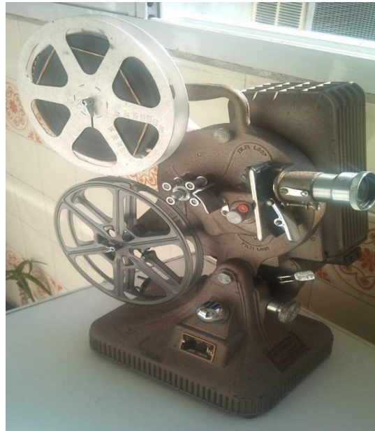
Figura 2 – Projetor de 16 mm (também como o JEFE, sem áudio, porém com maior qualidade de projeção 7
