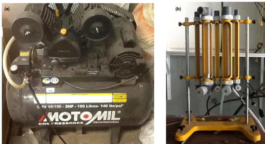
Figura 19 - Compressor (a) e rotâmetro (b).
