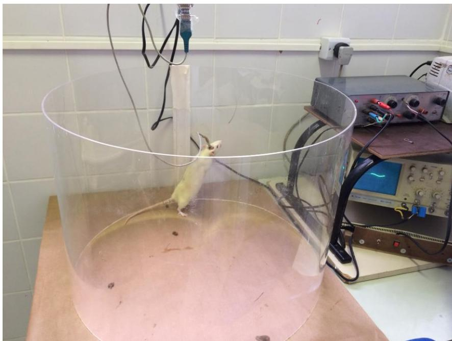
Figura 7: Montagem da estimulação elétrica intracraniana, onde pode-se observar o animal na arena de acrílico com eletrodo implantado conectado ao estimulador de pulso senoidal que é monitorado por um osciloscópio analógico. **Fonte:** Arquivo pessoal.
