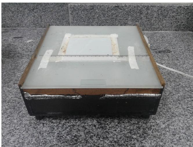
**Figura 3. 5** - Sistema de iluminação para obtenção de imagens digitais
