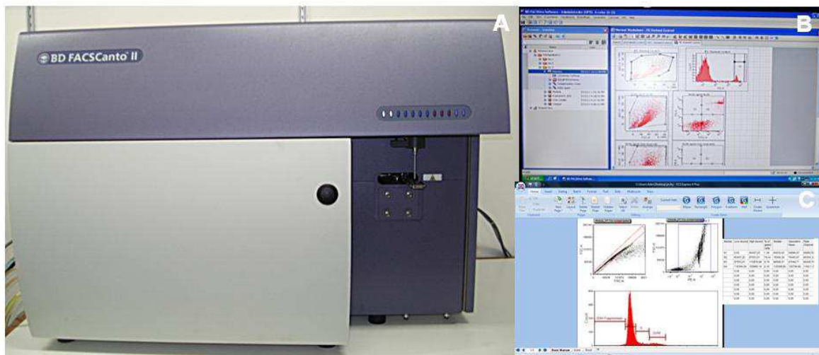
Figura 11 – A) Citômetro de fluxo FACSCanto II (BD) e layout dos softwares utilizados na análise dos dados FACSDiva (B) e FCS Express 4 Plus (C).
