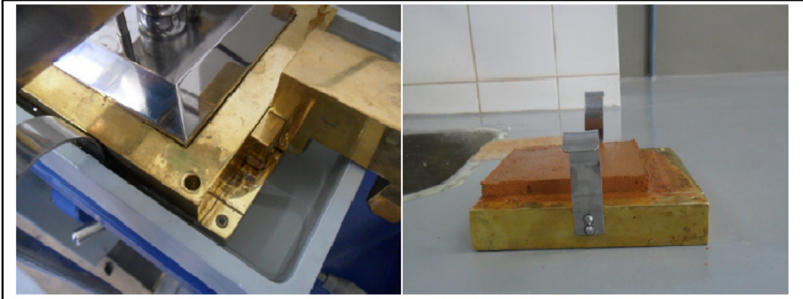
Figura 22 - Deslocamento do corpo de prova devido ao cisalhamento. Fonte: Autora, 2014.
