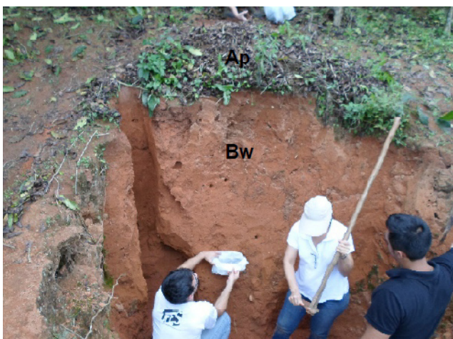
Figura 12. Coleta de amostras em trincheira. Fonte: Autora, 2014.
