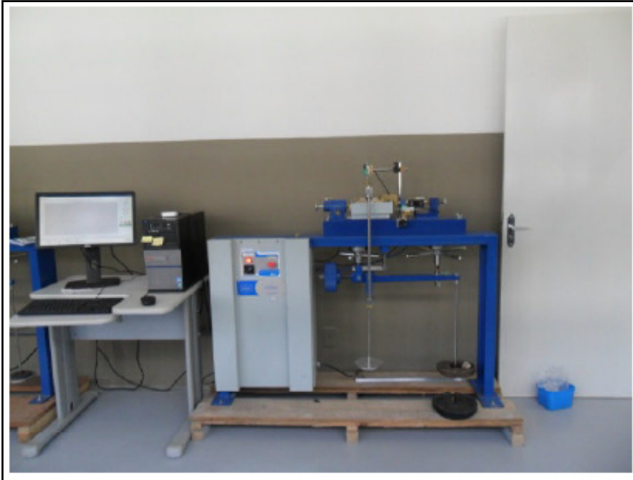
Figura 20 - Prensa de cisalhamento direto da fabricante Contenco acoplada ao computador. Fonte: Autora (2014).
