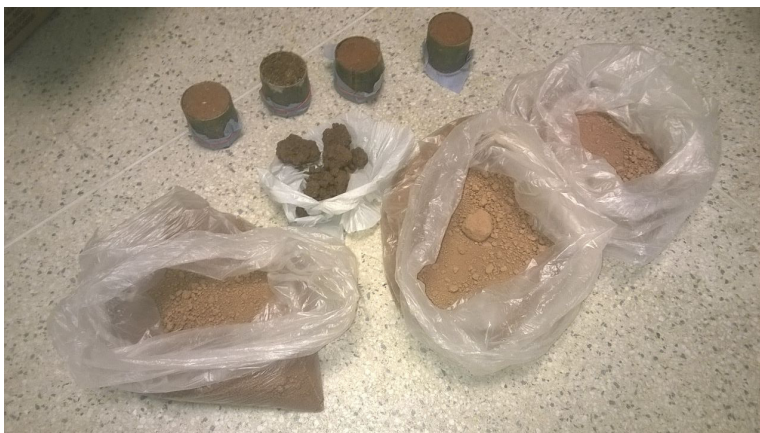
Figura 13. Amostras deformadas e indeformadas (anel volumétrico). Fonte: Autora, 2014.
