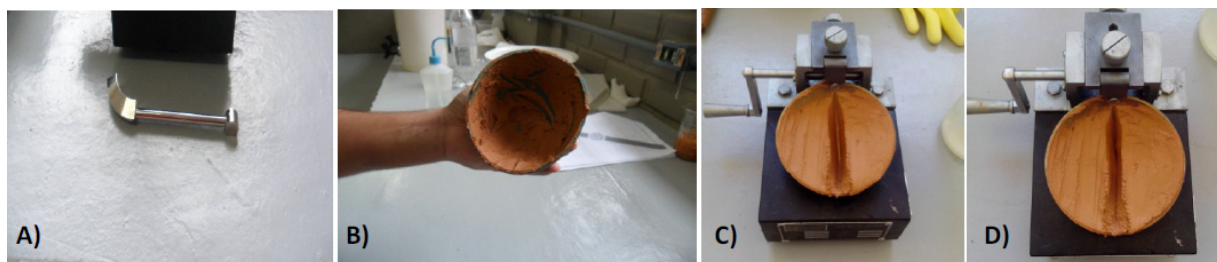
Figura 16 - Etapas para determinação do LL. A) Cinzel para solo argiloso; B) Homogeneização da amostra; C) Abertura do sulco; D) Fechamento do sulco.
