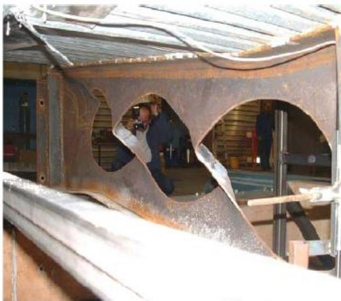
Figura 18 - Flambagem do montante da alma de viga mista
