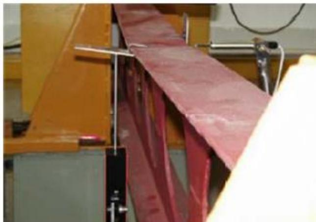
Figura 16 - Flambagem lateral com torção
