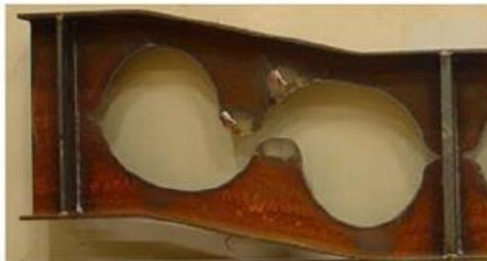
Figura 15 - Colapso da solda entre aberturas
