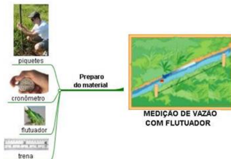
Figura 4: Esquemática da medição da vazão de um corpo hídrico com o método Flutuador.
