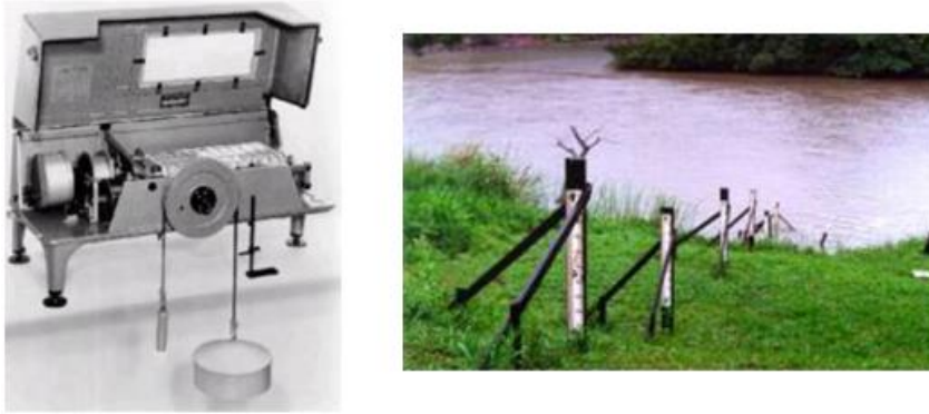
Figura 2 - (a) Linímetro de bóia e contrapeso; (b) Seção de régua linimétrica
