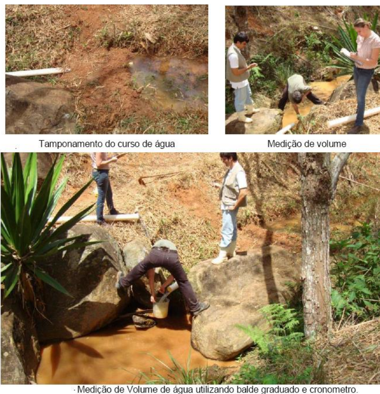
Figura 6: Medição de vazão através do método volumétrico direto na bacia do córrego Sossego (Adaptado de LABGEST, 2011c).
