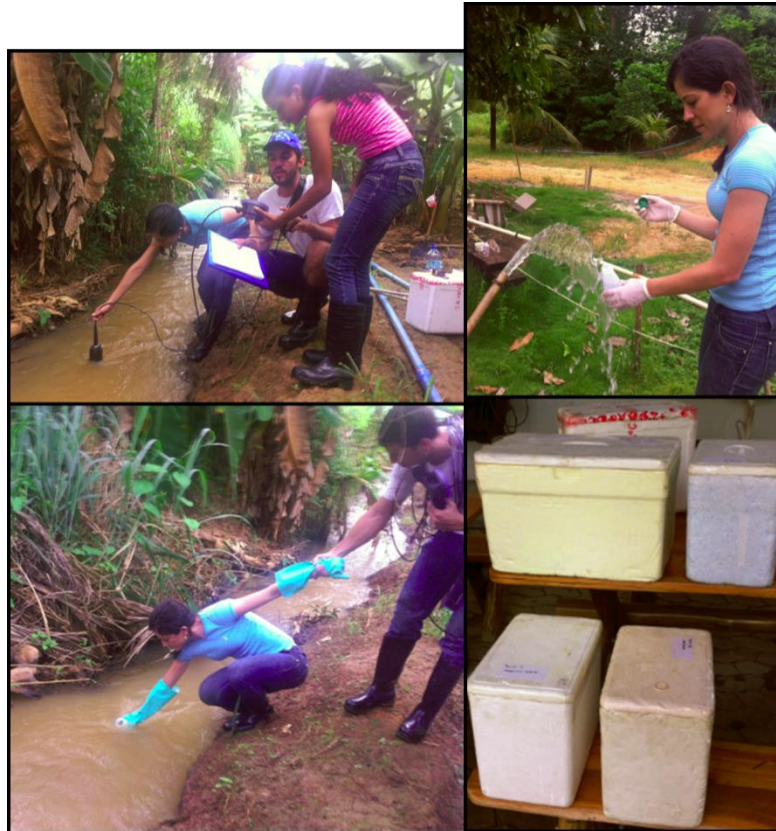
Figura 10 – Procedimento de medição, coleta e armazenagem das amostras de água
