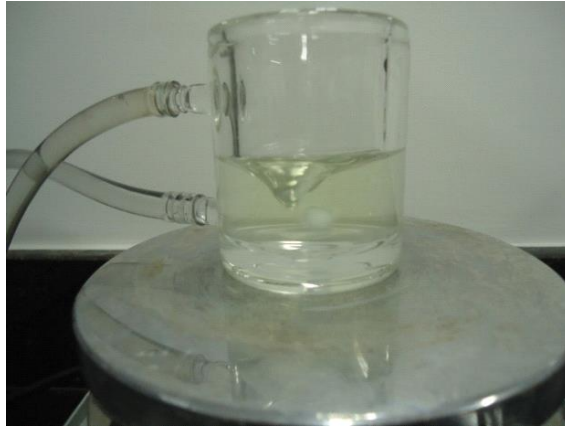
Figura 9: Microreator de mistura acoplado ao agitador magnético
