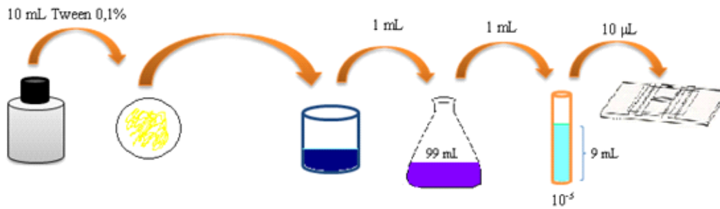
Figura 5: Esquema de diluição para contagem de esporos em câmara de Neubauer
