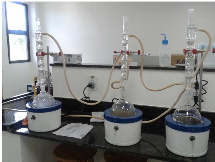
Figura 7: Refluxo para determinação da lignina de Klason
