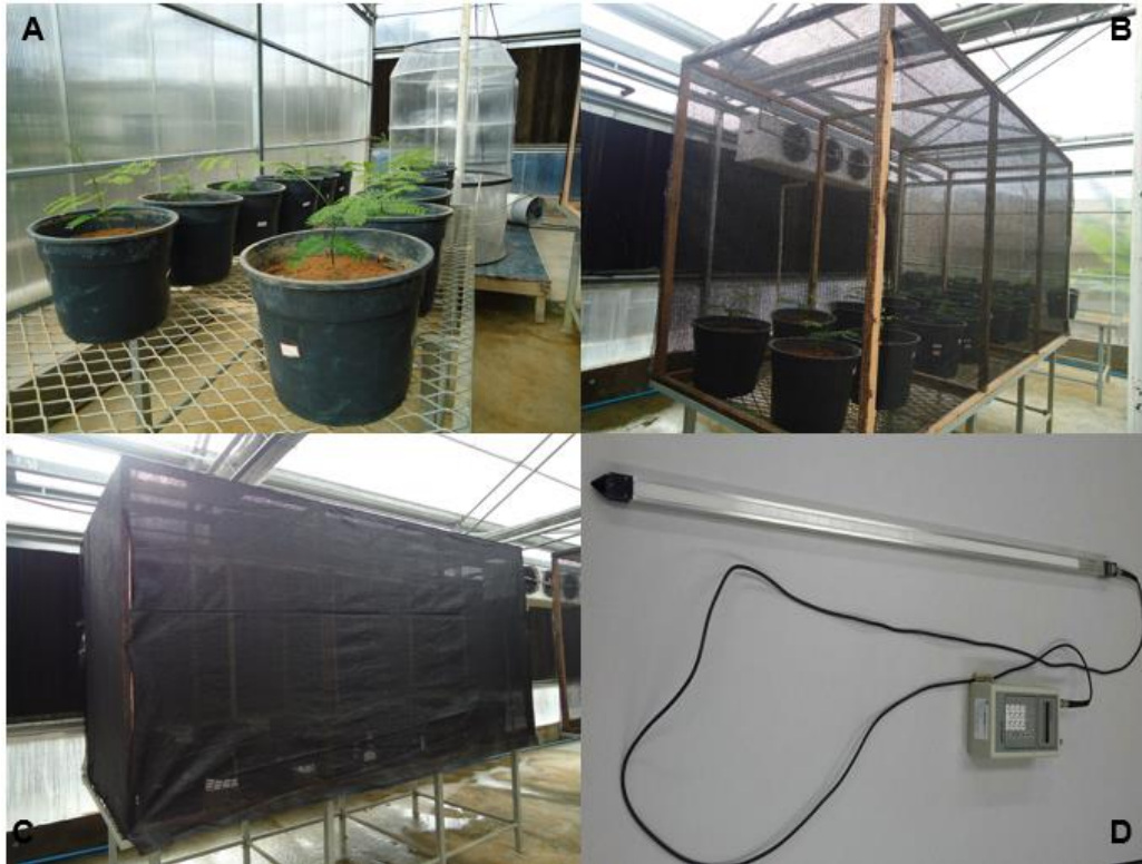
Figura 4 – Visualização do experimento e materiais utilizados no interior da casa de vegetação. Mudanças dispostas a pleno sol (A), mudanças dispostas no interior de estrutura de sombreamento (B, C) e sensor de barra com data logger marca LI-COR (D) para medição da radiação solar fotossinteticamente ativa (RFA).
