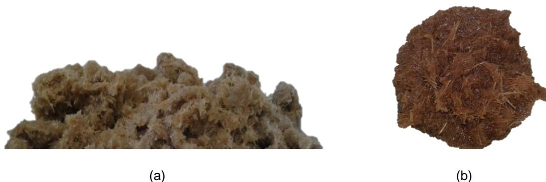
**Figura 11 - (a) Bagaço pós-tratamento e seco; (b) Bagaço pré-tratado, porém úmido**
