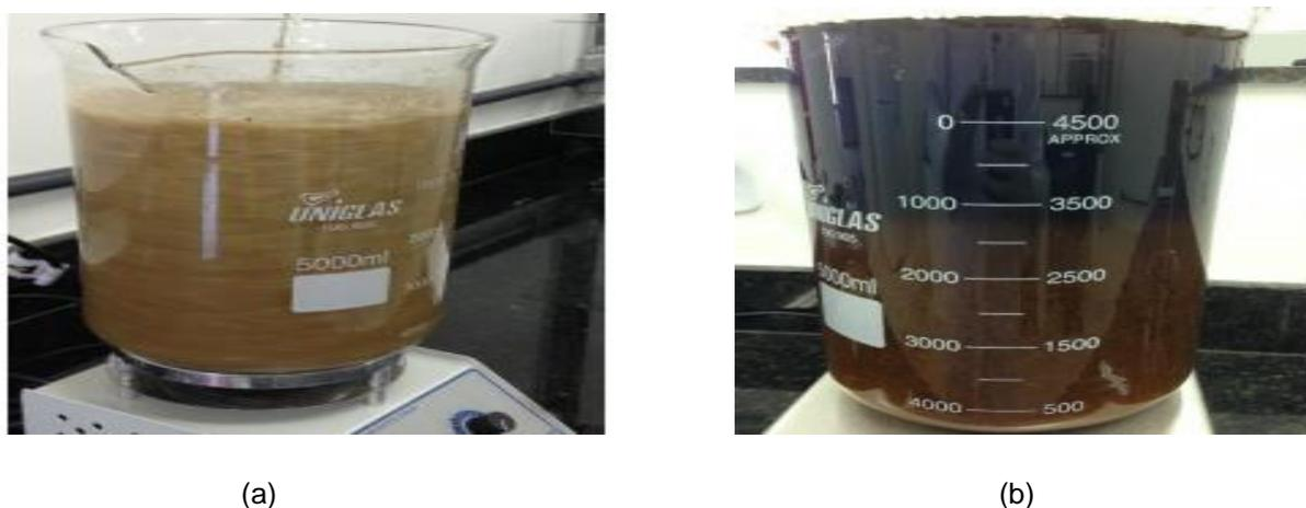
**Figura 18 - Pré-tratamento com ácido e base - (a) Tratamento com ácido sulfúrico; (b) Tratamento com hidróxido de sódio.**
