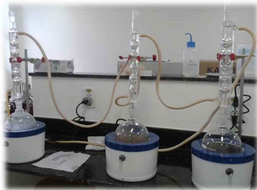
**Figura 12 - Sistema sob-refluxo para determinação da lignina**
