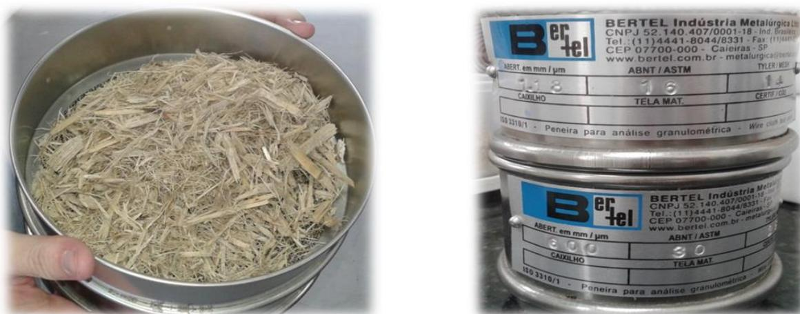
**Figura 10 - Peneiras Tyler para ajuste da granulometria do resíduo fibroso**
