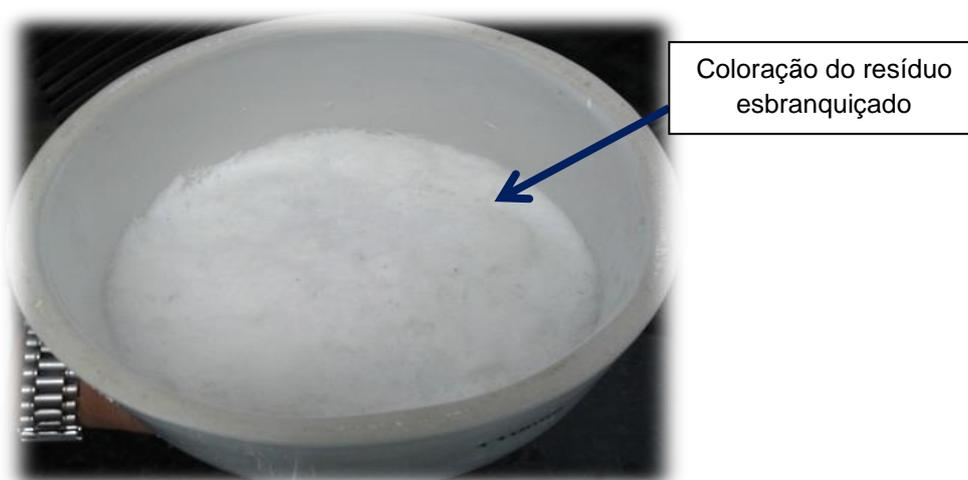
**Figura 13 - Resíduo depois de lavado com água a 5°C**
