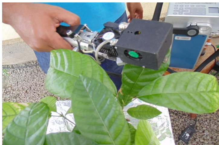
Figura 3. Medições de trocas gasosas realizadas em casa de vegetação com medidor portátil de fotossíntese.
