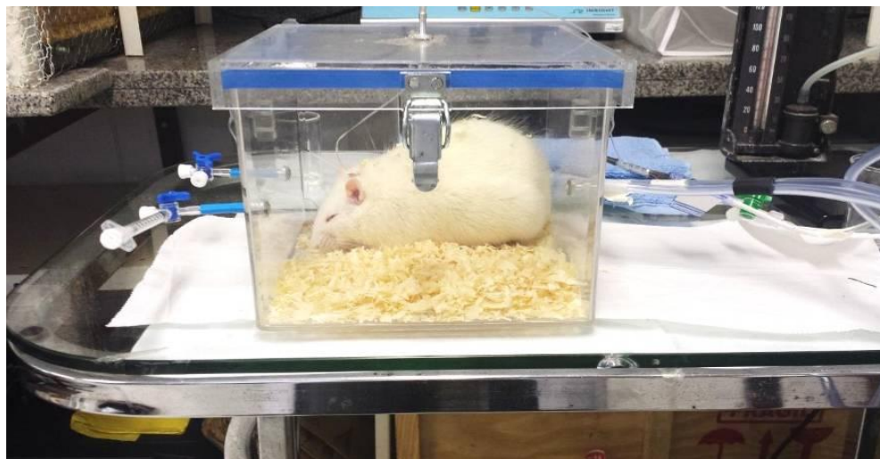
Figura 24: Rato Wistar dentro da câmara pletismográfica que permitia o registro dos parâmetros respiratórios.
