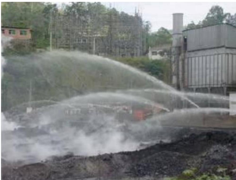
Após o resfriamento, a escória é transportada para a planta de britagem e, através de sistemas de correias, vai para uma peneira vibratória para fins de classificação e de separação magnética, sequencia esta ilustrada na Figura 9.
