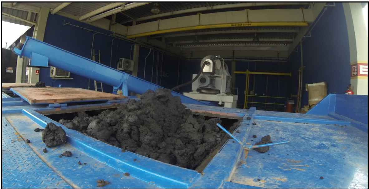
Figura 36 – Centrifuga ao fundo, caçamba de armazenamento e lodo centrifugado na ETE Araçás. Fonte: Produção do próprio autor.
