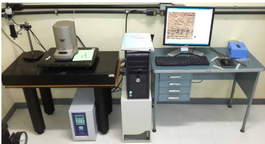
Figura 3.13: Microscópio de Força Atômica instalado nas dependências do Lemag.
