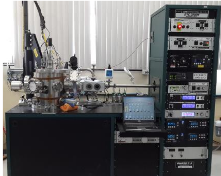
Figura 3.1: Magnetron sputtering modelo ATC Orion 8 produzido pela AJA International [25] instalado nas dependências do Lemag/Ufes.
