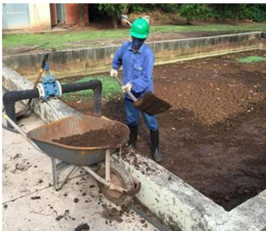
Figura 4.5: Coleta do lodo em LS para montagem da 1ª campanha.
