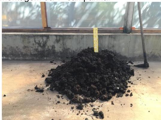
Figura 4.7: Entrada do lodo em estufa agrícola e disposição em leira (L2).
