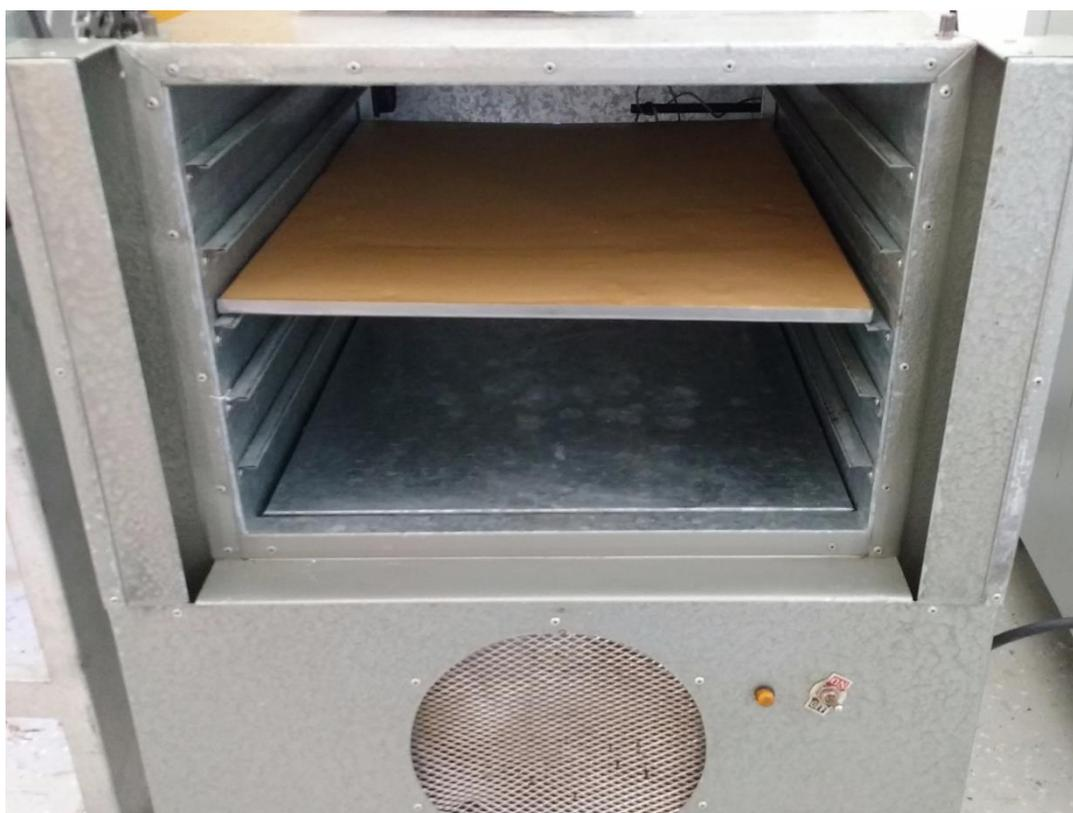
Figura 1 – Bandeja com espuma de extrato de café em secador convectivo.
