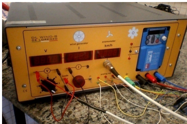
Figura 15 - Fonte de tensão, medição e controle Fonte: Captada pelo autor (2015)
