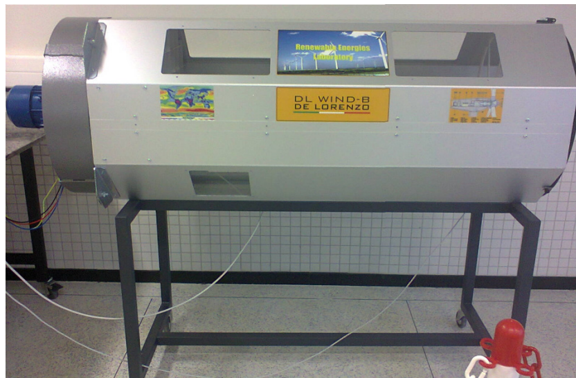
Figura 1 - Túnel aerodinâmico Fonte: Captada pelo autor (2015)
