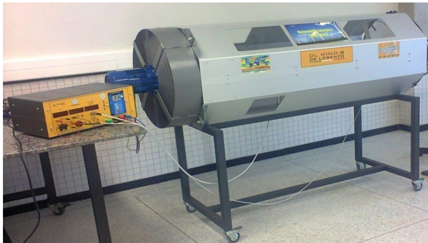
Figura 14 - Sistema eólico de baixa potência estudado (DLWIND-B) Fonte: Captada pelo autor (2015)
