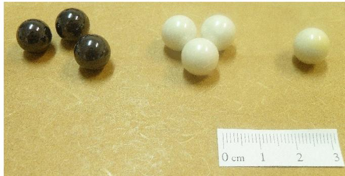
Figura 22 - Esferas de  $\text{Si}_3\text{N}_4$  (à esquerda), esferas de  $\text{ZrO}_2$  (centro) e esfera de  $\text{Al}_2\text{O}_3$  (à direita). Fonte: autor.
