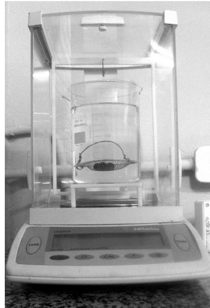
Figura 91 - (a) Esquema do aparato de pesagem. (b) Foto do suporte para medição da massa das amostras imersas em água. Fonte: autor.
