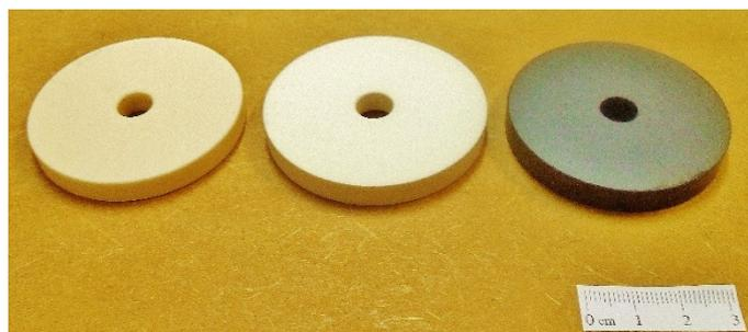
Figura 23 - Aspecto macroscópico de discos de  $\text{Al}_2\text{O}_3$  (à esquerda), ZTA (centro) e SiC (à direita). Fonte: autor.
