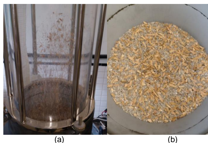
Figura 4.1 - Leito de jorro com mistura composta por 10% em massa de casca de coco e altura de leito estático de 8 cm: (a) regime de jorro (b) leito fixo.
