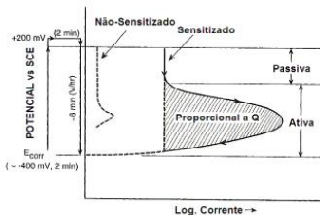
Figura 13 - Esquema da curva EPR para um aço AISI 304 sensitizado e não sensitizado (adaptação da norma ASTM G 108 – 94, 2004).
