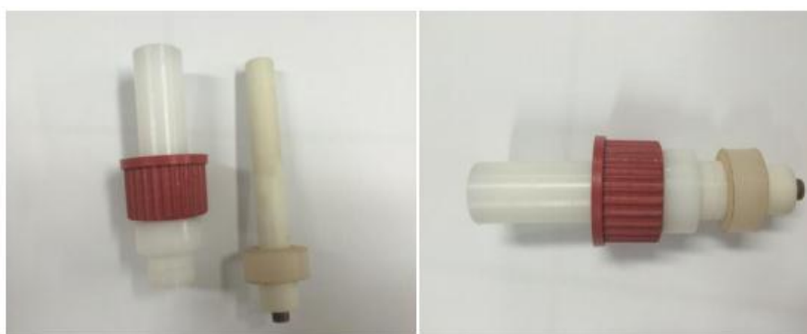
Figura 22 – Porta amostra da célula eletrolítica utilizada para os ensaios PERC.
