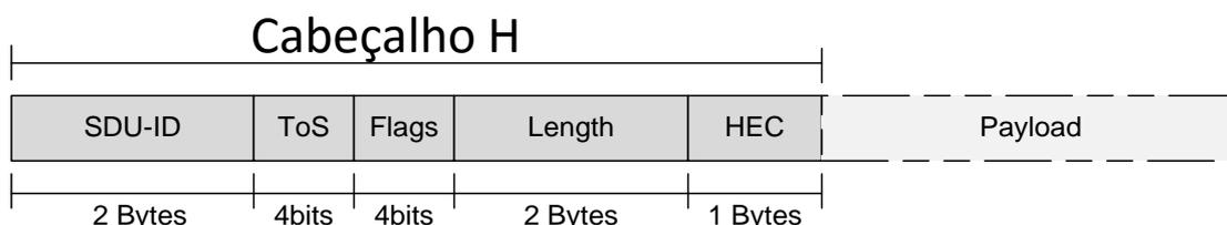
Figura 4.15: Estrutura do cabeçalho (H) da camada de adaptação.
