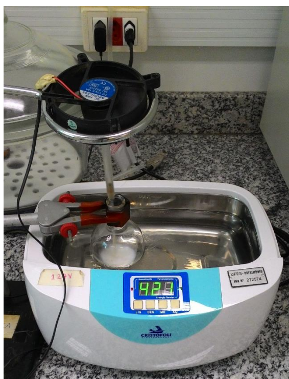
Figura 17: Sistema reacional com banho ultrassom e agitação mecânica.
