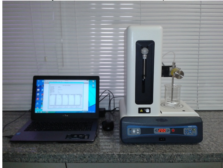
Figura 18: Detalhe do equipamento HIAC 9703+ durante a realização da análise do tamanho das partículas.
